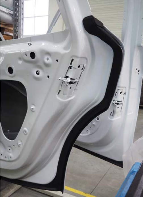
Die Dichtungselemente für die Seitentüren des Porsche Panamera werden als reines TPE-Teil gespritzt (© Hanser/C. Doriat)
