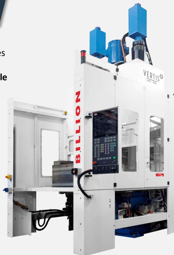
Des moteurs électriques performants, un pilotage hydraulique innovant, une fermeture en col de cygne sans colonnes et une conception favorisant l'accès à la zone moule, en toute sécurité, vous apporteront :
