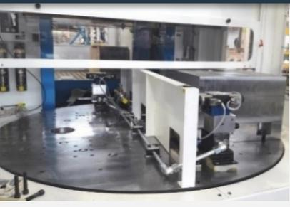
Um für die steigenden Erfordernisse, der neuen Märkte im Bereich des Kunststoffumspritzens, Lösungen zu bieten hat Billion seine vertikale Spritzgießmaschine **VERTIS V270 – 100 Tonnen** entwickelt.
