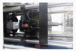
**Rotationsachse** integriert in die Spritzgießmaschine für 2 K und Umspritzanwendungen
